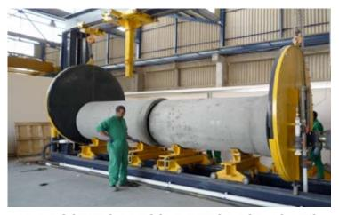
HYDROSTATIC PRESSURE TEST FOR JOINTS
